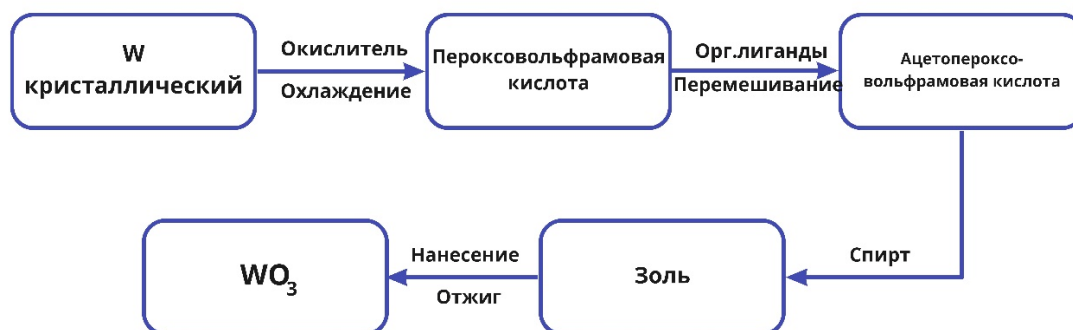
Рис. 2. Схема получения пленок WO_3 [11]
