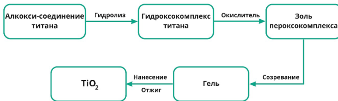
Рис. 4. Схема синтеза пленок \text{TiO}_2 [12]
