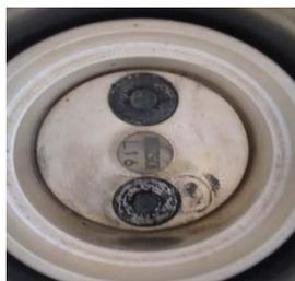
Рис. 1. Загрязненная в ходе неправильной работы измерительная ячейка ДСК по данным компании *NETZCH*
