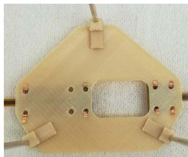
Рис. 8. Элемент держателя для детектора, выполненный из нейлона посредством 3D печати
