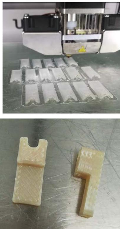
Рис. 5. Детали оправки, выполненные из нейлона (сверху) и из *Ultem*© (снизу)
