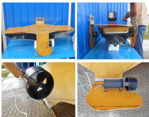
Рис. 1. Модель однокорпусного судна, подготовка к ходовым испытаниям
