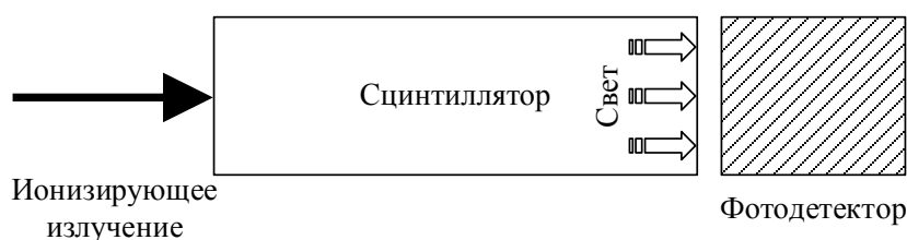
Рис. 1. Общая схема сцинтилляционного счетчика
