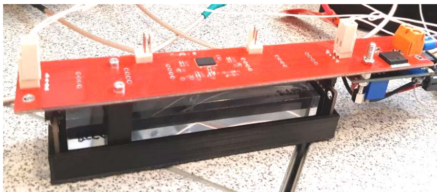
Рис. 7. Основная часть счетчика на базе NINO
