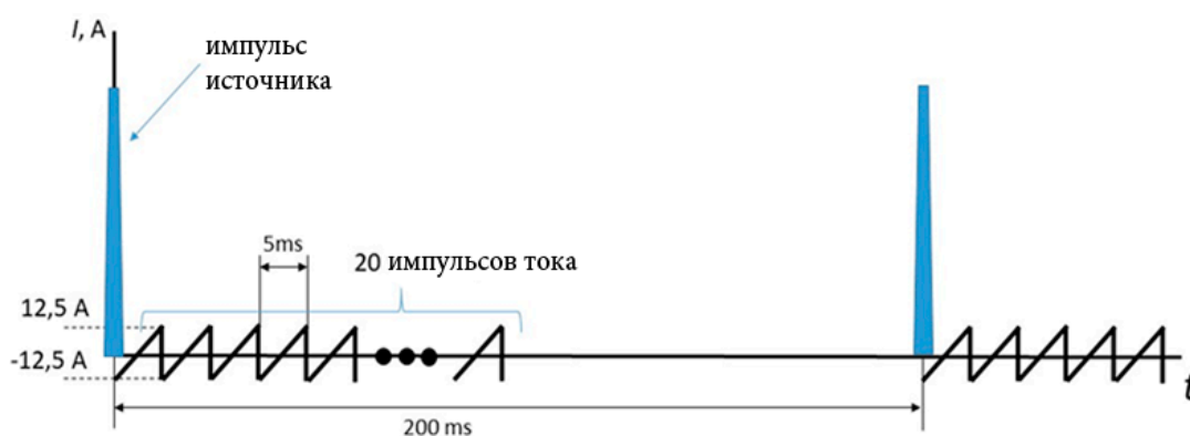
Рис. 6. Временная зависимость импульсов тока, протекающего в спиновых ротаторах
