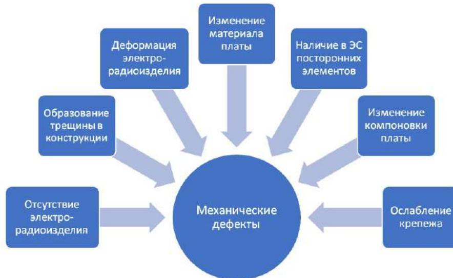
Рис. 2. Типы механических дефектов, выявляемые по ударным воздействиям
