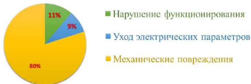
Рис. 1. Распределение отказов радиокомпонентов по видам дефектов
