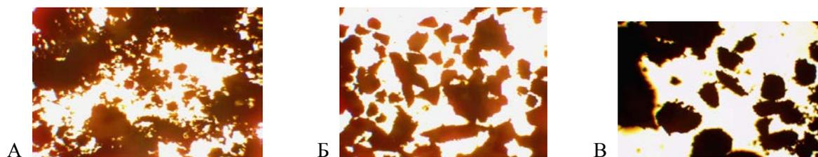
Рис. 5. Оптические изображения ПАНИ, синтезированных с использованием различных кислот: А – H<sub>2</sub>SO<sub>4</sub>; Б – HClO<sub>4</sub>; В – HCl (увеличение микроскопа x 50)
