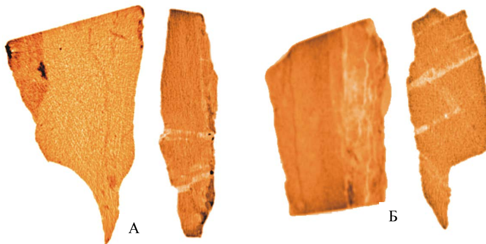
Рис. 3. Томограммы марганцевых руд Усинского месторождения: А – родохрозитовая руда и Б – манганокальцитовая руда; родохрозит I генерации темно-рыжее, родохрозит II генерации – рыжее, прожилки манганокальцита – белое, гидроксиды марганца – черное
