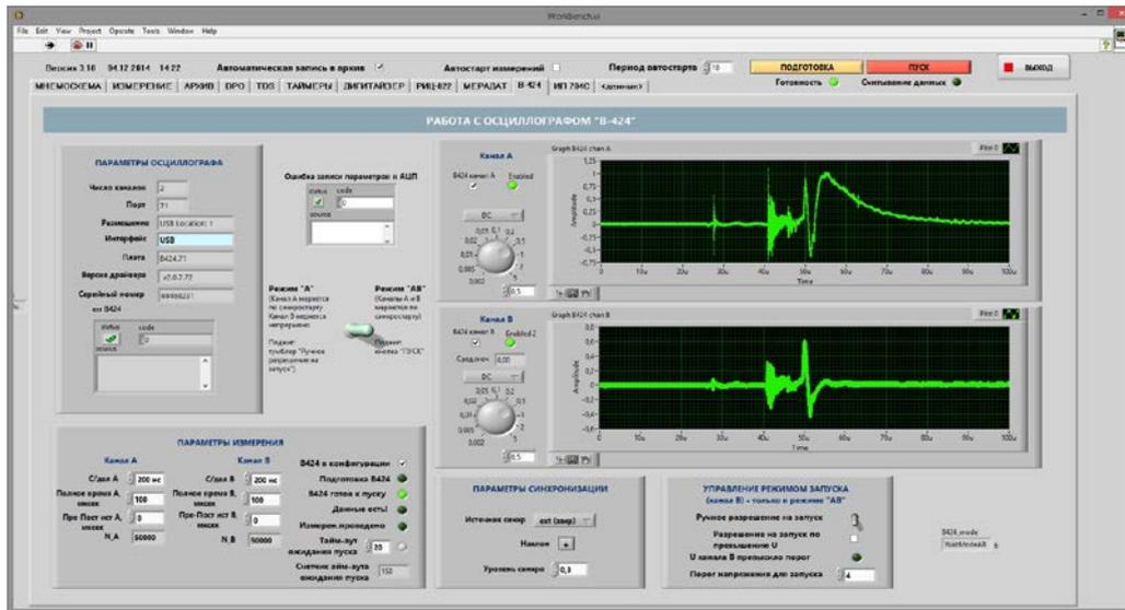
Рис. 2. Окно отображения измеренных сигналов с осциллографа В-424
