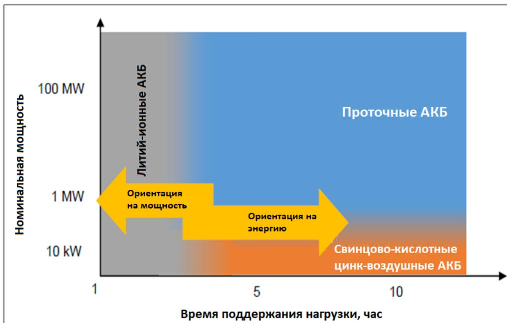
Рис. 5. Технологии накопления энергии в зависимости от времени поддержания и мощности
